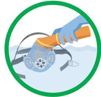
Um Schmutz und Ablagerungen zu entfernen, reinigen Sie die Maske manuell durch Eintauchen in warmes Wasser mit neutralem Reinigungsmittel und Abschrubben mit einer weichen Bürste, bis sie sauber ist. Spülen Sie die Maske gründlich mit frischem, warmem Wasser.
