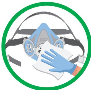
Desinfizieren Sie die Maske durch Eintauchen, Abwischen oder Besprühen gemäß den Anleitungen der Gesundheitseinrichtung und der Gebrauchsanweisung. Spülen Sie die Maske gründlich mit frischem, warmem Wasser. Lassen Sie die Maske an der Luft in einem nicht kontaminierten Bereich trocknen.
