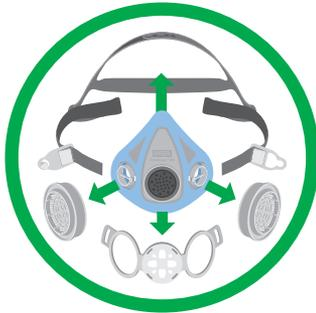
Entfernen Sie die Filter und zerlegen Sie die Maske.
